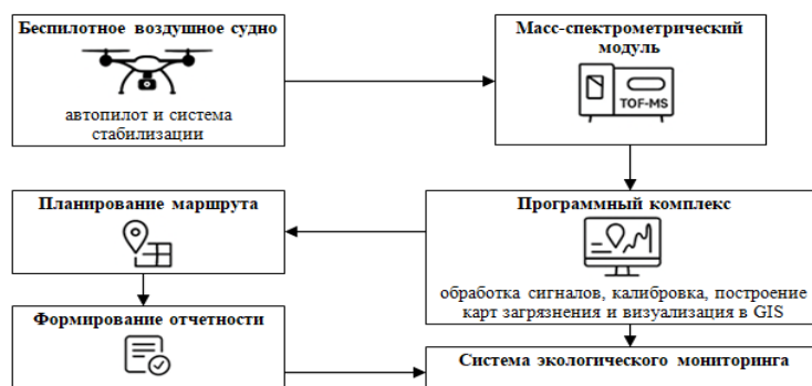
Рисунок 1 – Схема концептуальной модели работы системы БВС+TOF-MS
