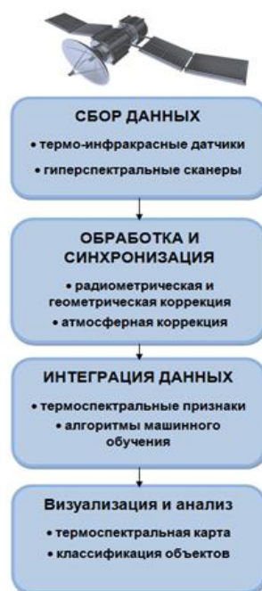
Рисунок 1 – Процесс термоспектральной разведки
