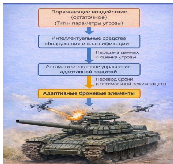
Рисунок 3 – Функциональная схема внутреннего уровня защиты боевой техники от беспилотных летательных аппаратов
