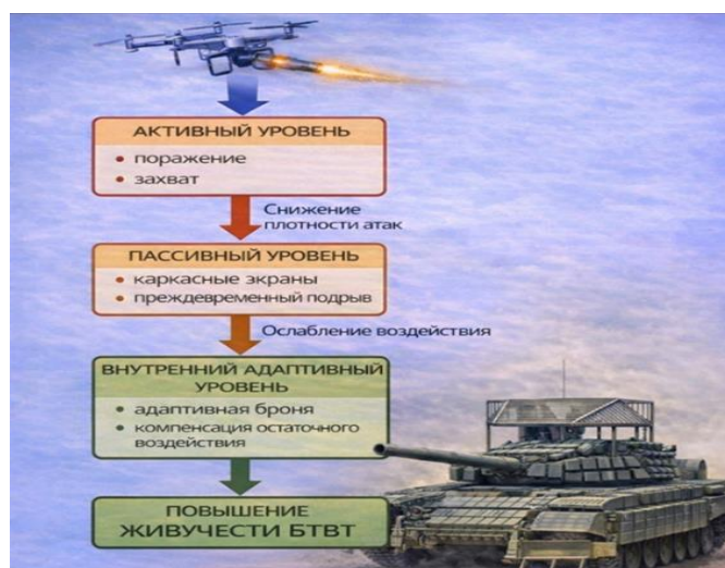
Рисунок 4 – Функциональная схема многоуровневой защиты боевой техники от беспилотных летательных аппаратов
