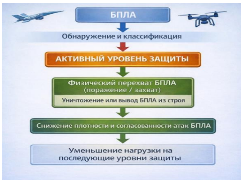
Рисунок 1 – Функциональная схема активного уровня защиты боевой техники от беспилотных летательных аппаратов
