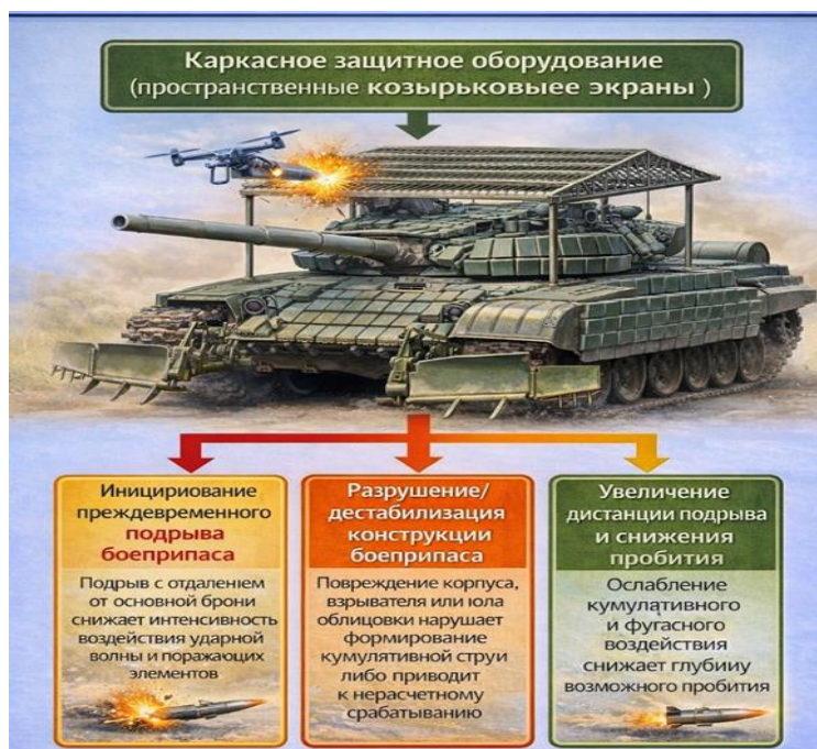
Рисунок 2 – Функциональная схема пассивного уровня защиты боевой техники от беспилотных летательных аппаратов
