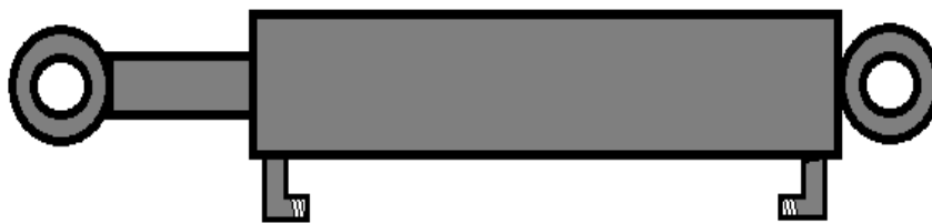
Рисунок 3 – Гидроцилиндр с односторонним штоком (двухстороннего действия)
