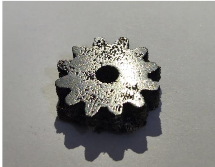
Рисунок 5 – Пилотная печать шестерни на экспериментальной лабораторной аддитивной установке выборочного лазерного плавления
