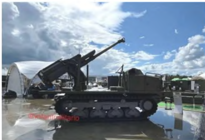
Рисунок 6 – Артиллерийский беспилотный наземный аппарат (БНА) на базе гусеничного роботизированного шасси МТС-15 с 122-мм гаубицей 2А18М (Д-30)
