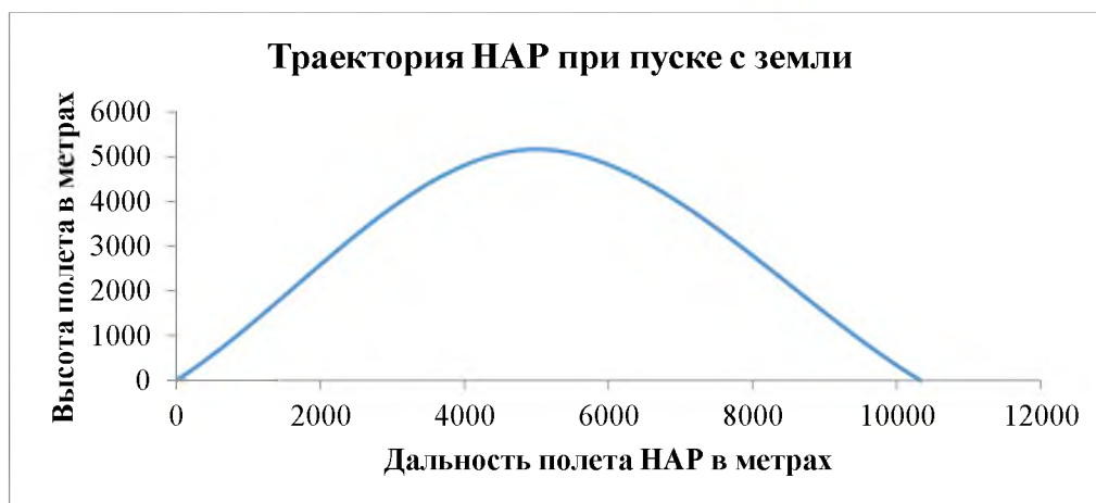
Рисунок 2 – траектория НАР при пуске с наземной установки
