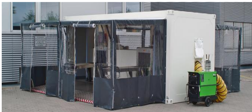
Рисунок 4 – Пример использования защитных штор при плохих погодных условиях
