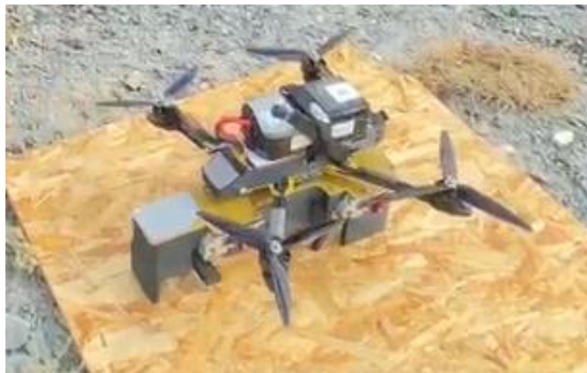
Рисунок 2 – FPV-дрон, снаряженный гранатой РКГ-3, на площадке взлета
